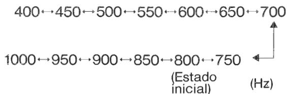
3. Cuando se pulsa nuevamente la tecla PITCH, se fija el paso, y se regresa al estado normal.
