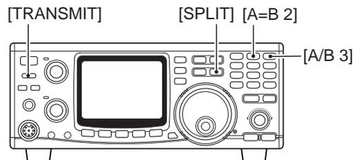
La comunicación en modo cruzado se puede realizar usando la función de frecuencia split. (e.g. USB y CW)
