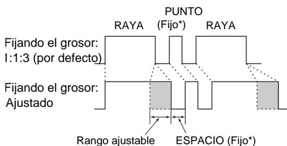
\*La longitud del ESPACIO y el PUNTO se pueden ajustar solamente con la velocidad de picado (keying).
