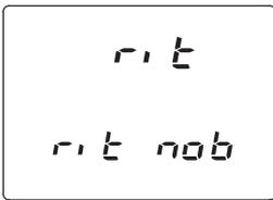
El control [RIT] funciona como [RIT] incluso cuando la función de dial de sintonización SUB esté en uso. (por defecto)
